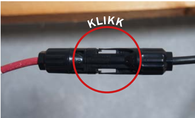
FONTOS! Csatlakozók összeillesztésénél ügyelni kell, hogy a fülek bekattanjanak egymásba!
